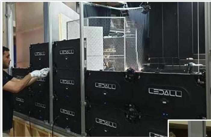
Die hochpräzisen CNC bearbeiteten Alu Druckguß Gehäuse mit integrierten Positionierungshilfen und Schnellverbindern machen die Montage zum Kinderspiel.
